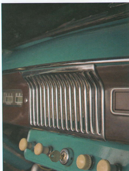
❺ Выступающие рычаги управления и замок зажигания расположили по центру приборной панели. С точки зрения обеспечения безопасности, это решение нельзя назвать оптимальным: при аварии пассажиры с заднего сидения могли травмировать голову о ключ зажигания. В других моделях неудобное расположение ключа приводило к травме коленной чашечки.
