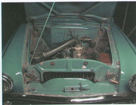
❷ Свободный доступ к двигателю обеспечивал капот «аллигаторного типа».
