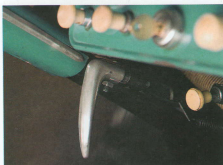
❹ Ключа с металлическим набалдашником на самом деле — всего лишь рычаг стояночного (ручного) тормоза.
