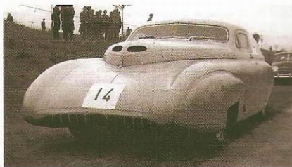
«Победа-Спорт» образца 1954 года с двигателем без роторного нагнетателя. На ней выступал гонщик М. Метелев
